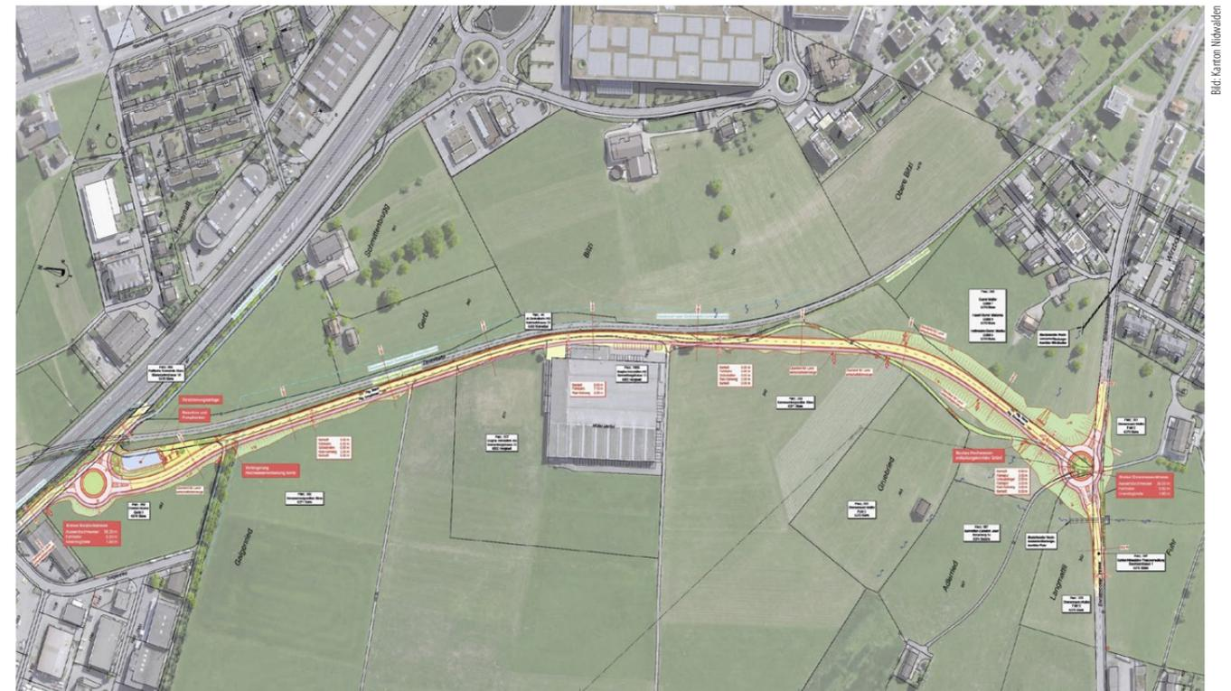
Die Entlastungstrasse Stans führt dem Zentralbahntrasse entlang, wobei die beiden Anschlussknoten als Kreisel ausgeführt werden.
