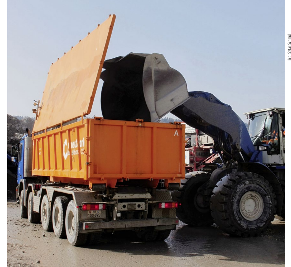
Durch die Begasung von Abbruchmaterial wird CO 2 zu Kalkstein mineralisiert. Mit dem Verfahren erzielt das Jungunternehmen Neustark Negativemissionen.
