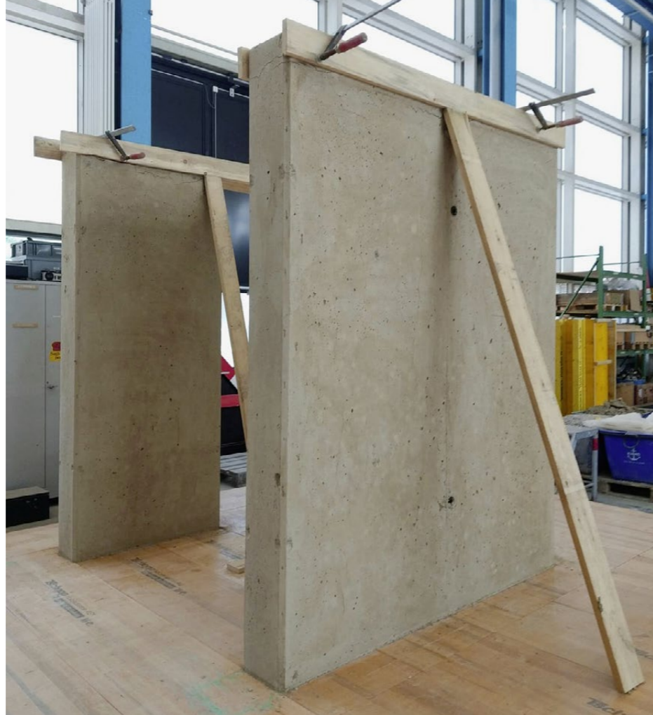
Die Lösung des ETH-Spinoff Oxana bildet eine Alternative zu herkömmlichem Beton. Lehmhaltiges Aushubmaterial ohne Zement lässt sich zu Böden oder nichttragenden Wänden verarbeiten.
