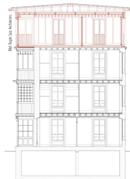
Die Anschlüsse zwischen dem massiven Unterbau und der leichten Aufstockung erforderten viele Untersuchungen und Detailstudien.
