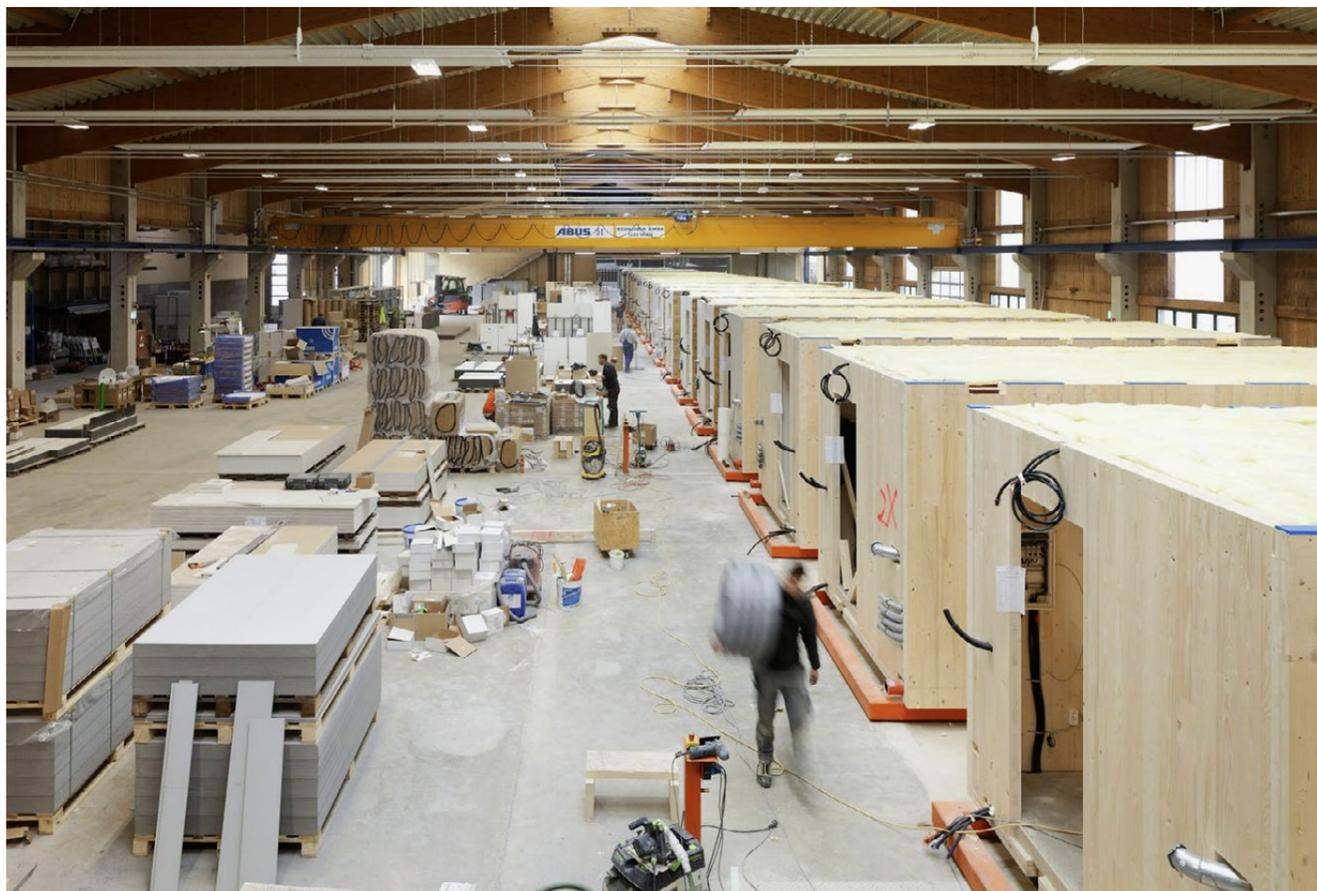
Die Holzmodule werden in der Produktionshalle der Kaufmann Bausysteme GmbH laufend hergestellt.
