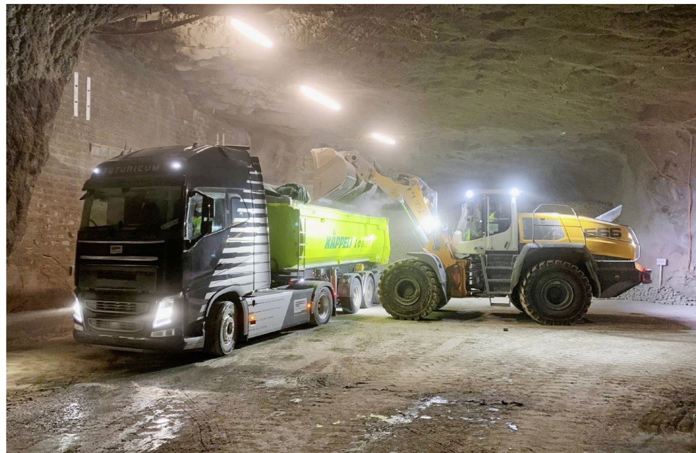
Beim Untertagebau können elektrisch betriebene Nutzfahrzeuge ihre Vorteile ausspielen. Standard ist allerdings nach wie vor, die Energie für sämtliche Antriebe über einen Dieselmotor zu erzeugen.
