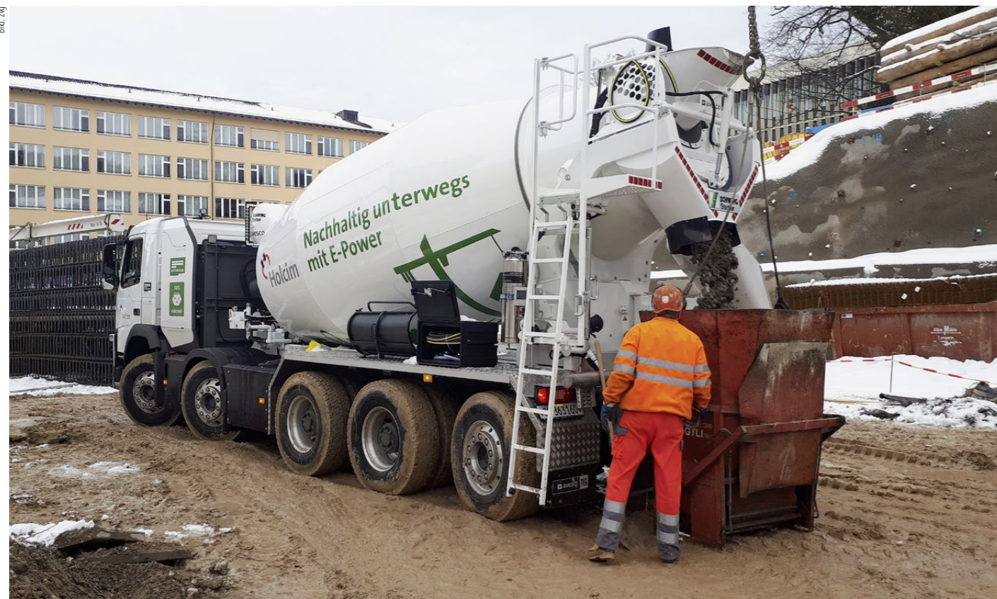
Einige wenige voll elektrifizierte Beton-Fahrmischer sind bereits auf Schweizer Strassen unterwegs. Einer von vielen kleinen Schritten, die die CO 2 -intensive Branche unternimmt, um ihre Klimabilanz zu verbessern.
