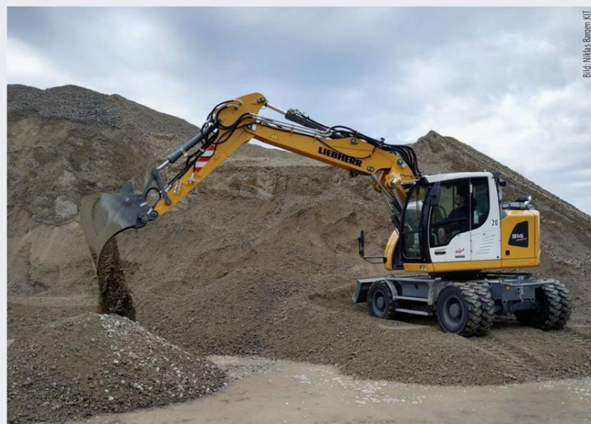
Dieser mit Sensoren gespickte, 15 Tonnen schwere Hybrid-Bagger wurde hundert Tage lang bei der Arbeit auf unterschiedlichen Baustellen überwacht. So konnte berechnet werden, wie viel Einsparpotential der elektrische Betrieb etwa des Schwenkwerks birgt, während der Bagger selbst weiterhin mit Diesel betrieben wird. Derartige Lösungen sollen Übergangstechnologien bis zur vollständigen Elektrifizierung bilden.
