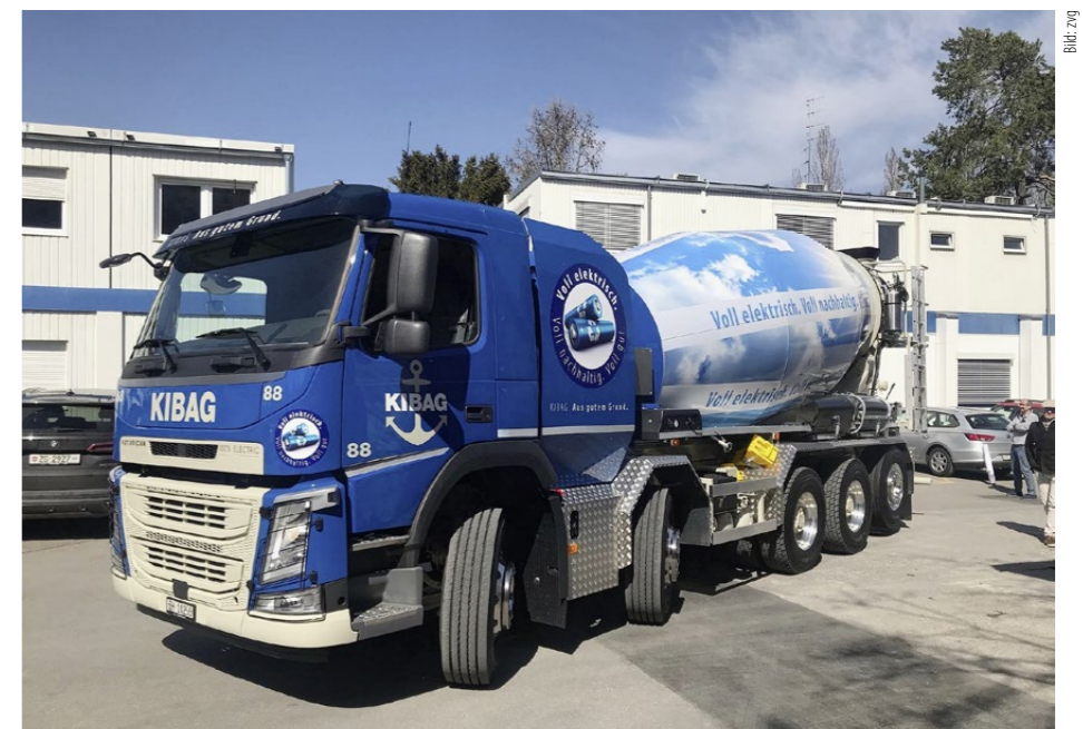
Liebherr hat letztes Jahr dem Unternehmen Kibag einen vollelektrischen Betonmischer geliefert. Für den Betrieb in der Stadt ist die Reichweite passend.
