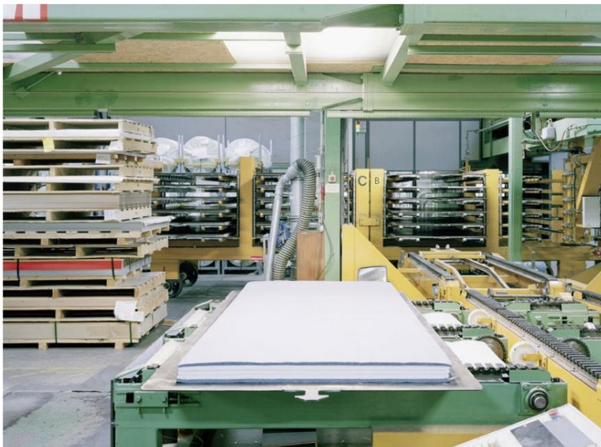
Die Matten werden bei niedriger Temperatur, aber mit extrem hohem Druck zu Hartfaserplatten gepresst. Für den ganzen Prozess wird kein Wasser benötigt.
