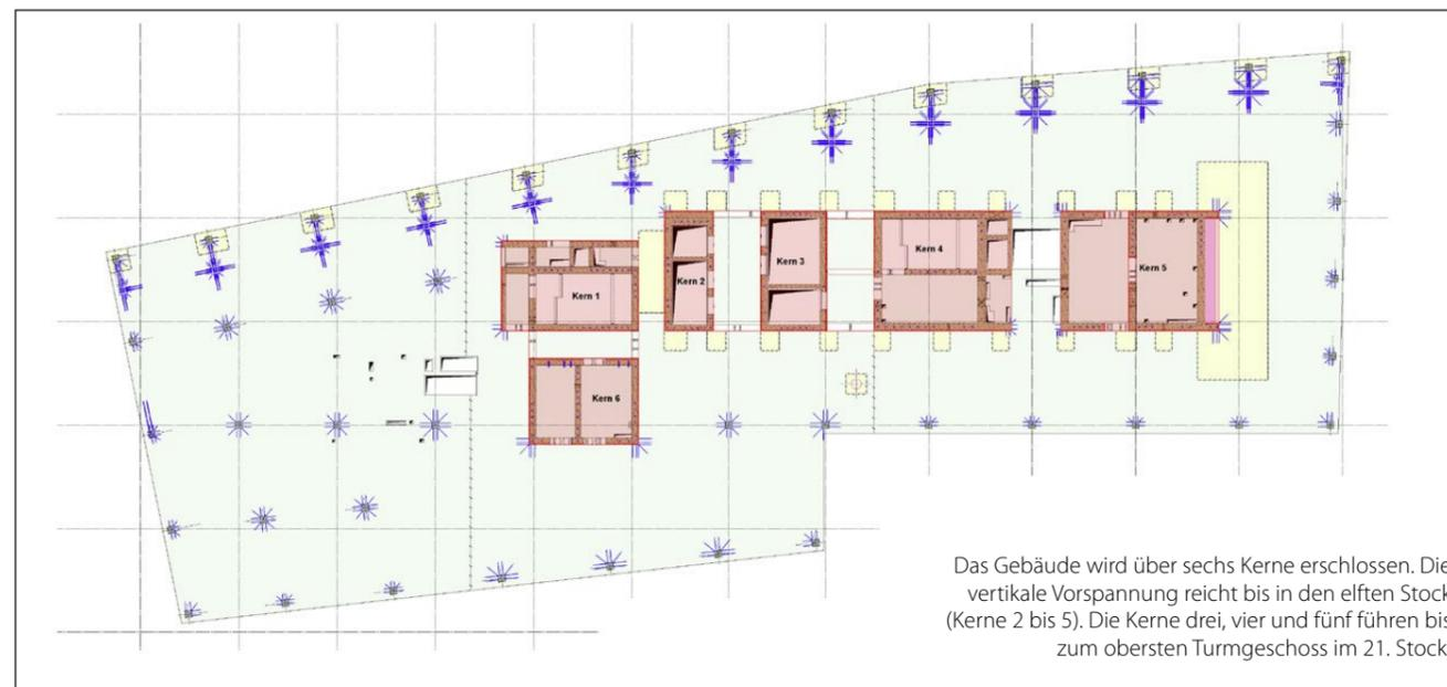
Das Gebäude wird über sechs Kerne erschlossen. Die vertikale Vorspannung reicht bis in den elften Stock (Kerne 2 bis 5). Die Kerne drei, vier und fünf führen bis zum obersten Turmgeschoss im 21. Stock.
