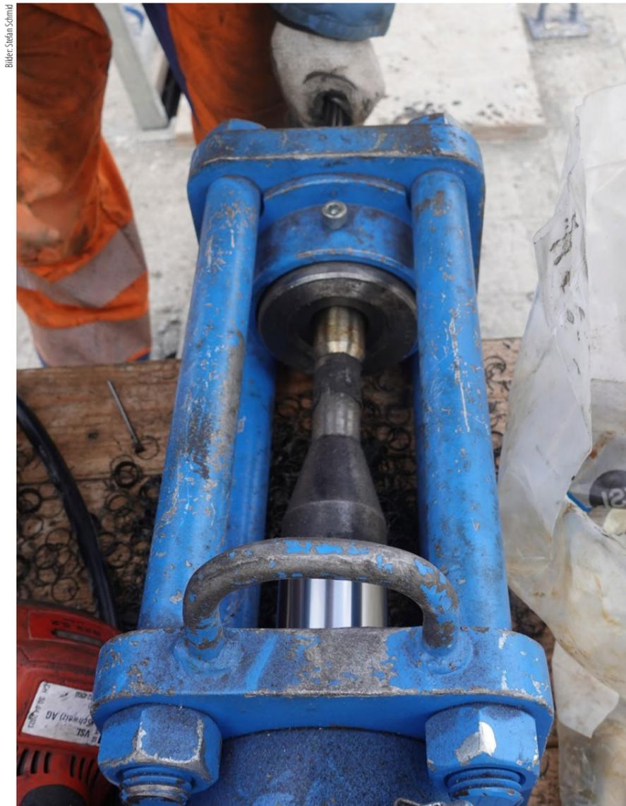
Die Stahlkabel werden für die Fixierung in den Presshülsen vorbereitet.
