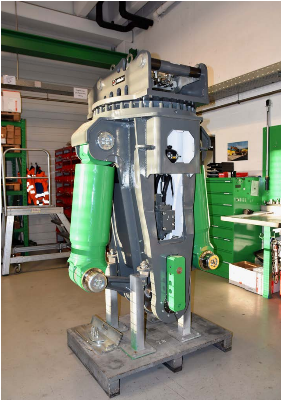
Aus eigener Entwicklung und Fertigung am Firmenstandort in Rossrüti stammt der bullige Betonbeisser von Egli, der mit wechselbaren Gebissen gezielt verwendbar ist.
