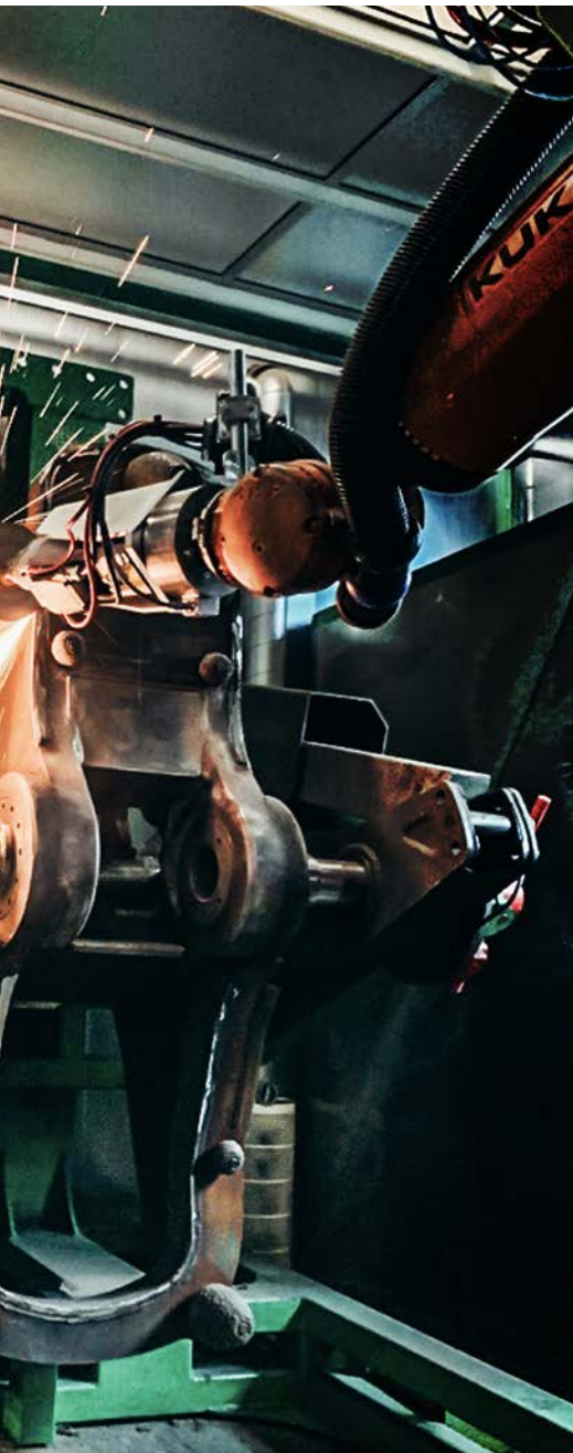
Aber für das mühsame Abschleifen der Schweissgrate
