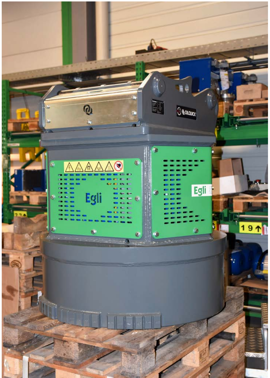
Der zugstarke Abbruchmagnet von Egli wird hydraulisch angetrieben und lässt sich rasch an beliebigen Trägergeräten durchwechseln.
