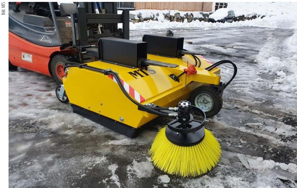
Kehrmaschinen mit Eigenantrieb können an völlig beliebigen Trägerfahrzeugen betrieben werden. Eine exklusive Lösung hat der Hersteller MTS entwickelt – nämlich einen hydraulischen Antrieb.
