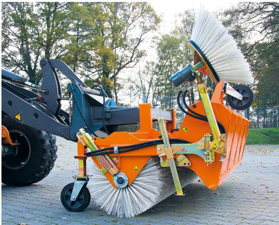
Rotierenden Kehrwalzen sind schon länger für die Reinigung von Freiflächen und Strassen zuständig. Die starren Blockbesen kamen erst vor rund 15 Jahren heraus.
