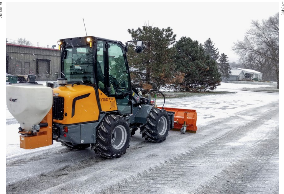
Mit Schneeschild und Streuer wird der Giant V452XTRA schnell zum Räum- und Streufahrzeug. Zusätzliche LEDs machen ihn weithin bemerkbar.
