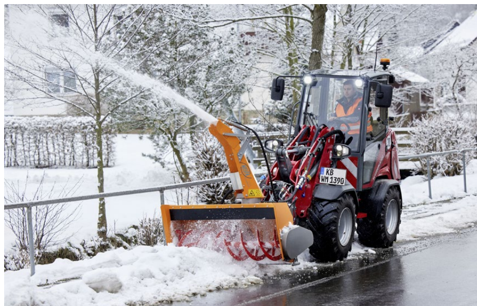
Der Weidemann 1390 hat einen Anbaugeräte-Modus, der Belastungsspitzen abfängt, wie sie beim Betreiben einer Schneefräse vorkommen.
