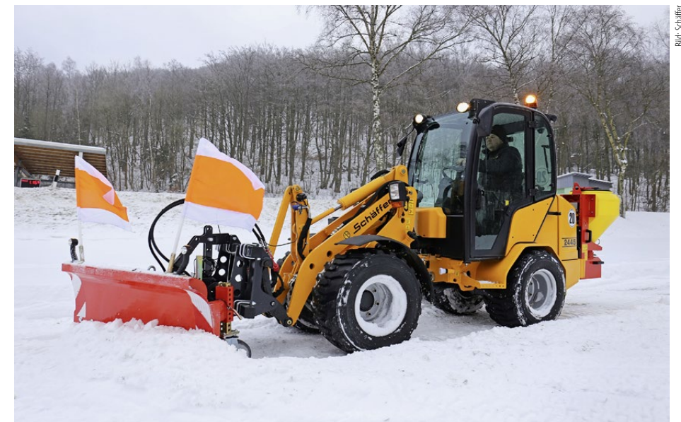
Der kompakte Schaffer 2445 mit Schild und Streuer unterwegs. Mitsamt einer Fahrerkabine kommt er auf ein Einsatzgewicht von 2700 Kilogramm.
