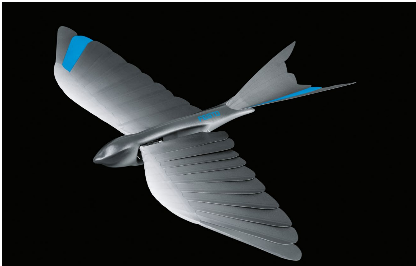
Gerade mal 42 Gramm leicht, autonom flugfähig und mit GPS und Breitband-Technologie ausgestattet: Der «Bionic Swift» verfügt über verblüffend viel Technik auf aller kleinstem Raum.
