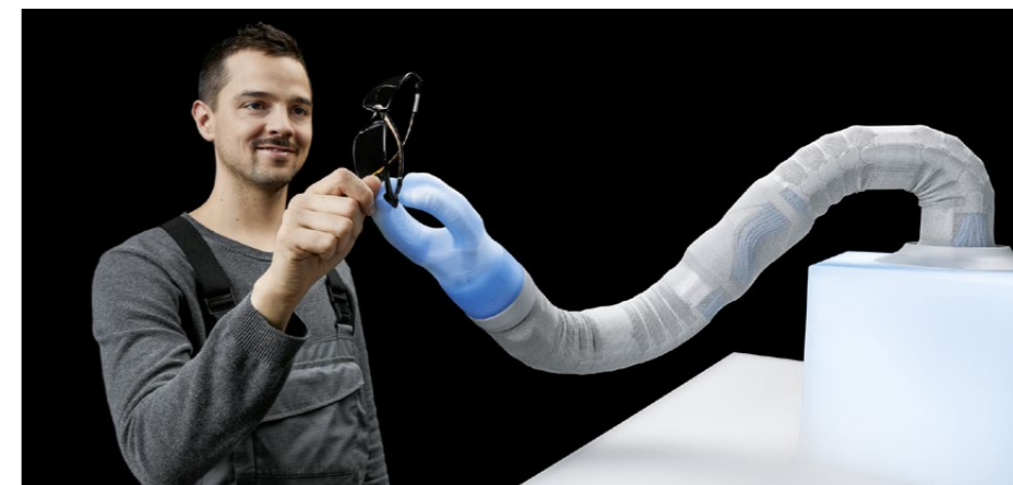
Die «Bionic SoftHand» und der «SoftArm» im Zusammenspiel: Der Roboter kann ohne Sicherheitsmassnahmen mit Menschen zusammenarbeiten und lernt dank künstlicher Intelligenz selber, wie er gestellte Aufgaben am besten löst.
