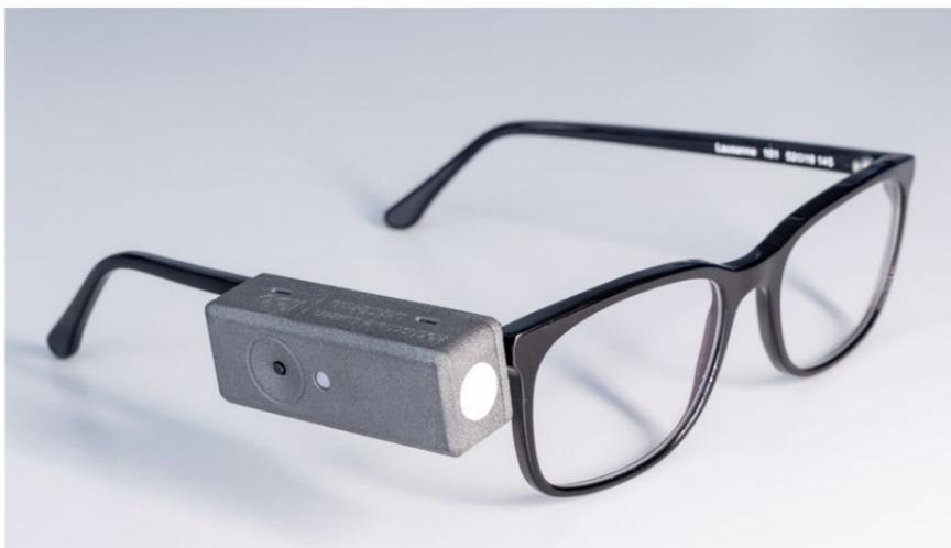
Das an der Hochschule Luzern entwickelte Licht-Dosimeter zeichnet die Lichtmenge und Zusammensetzung der Wellenlängen über längere Zeiträume auf.
