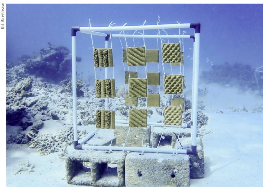
Bei der Testinstallation auf den Malediven verwendeten die Forscherinnen flache Ton-Ziegel mit unterschiedlichen Oberflächen.
