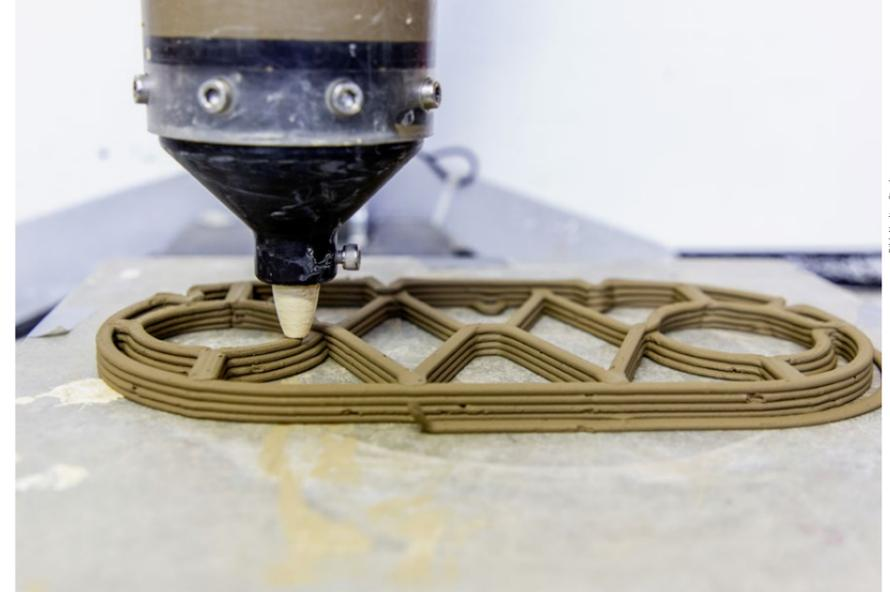
Der 3D-Drucker benötigt eine Stunde und zwanzig Minuten, um einen Baustein zu drucken.
