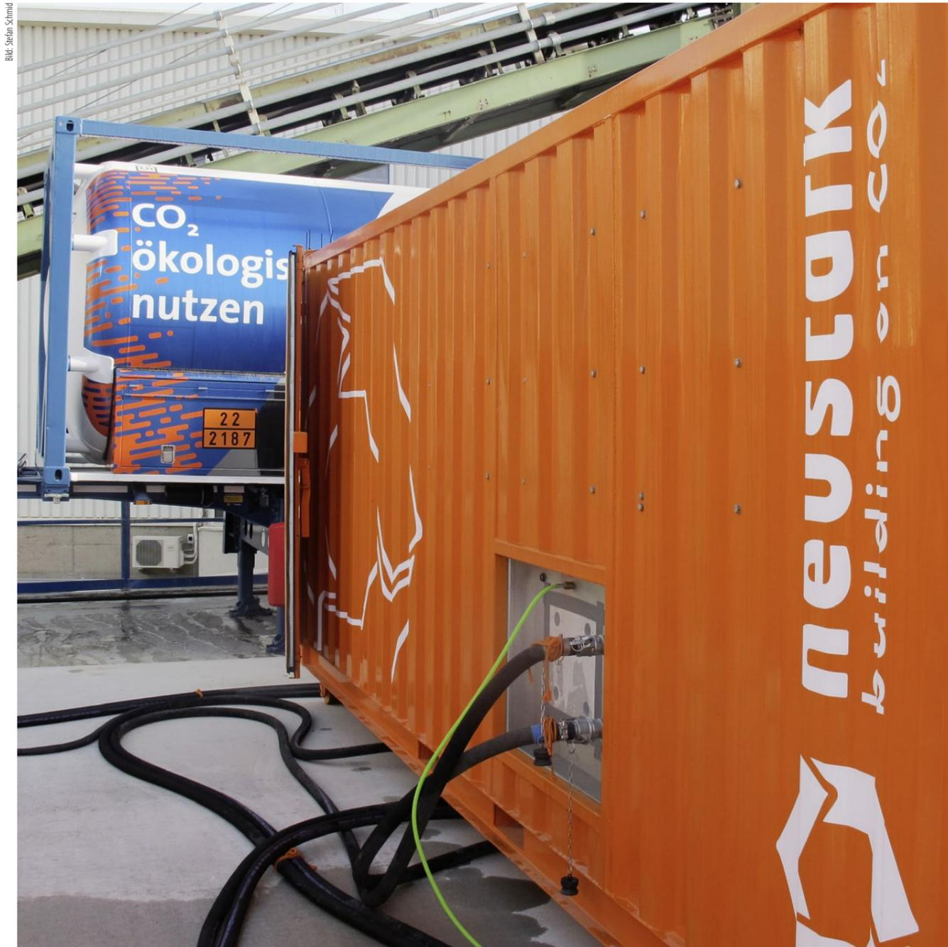
Der Tank enthält 20 Tonnen flüssiges CO<sub>2</sub>. Damit lassen sich 2000 Kubikmeter Frischbeton herstellen. Im Container befindet sich die Prozesssteuerung.
