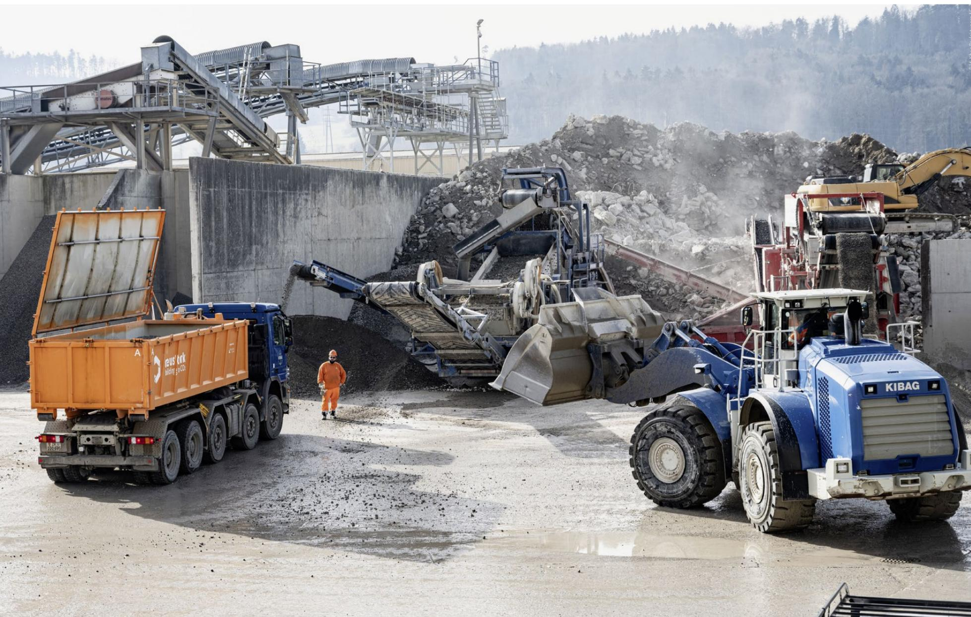
Direkt von der Aufbereitungsanlage der Kibag befüllt der Radlader den Container mit 15 Kubikmeter Betongranulat.
