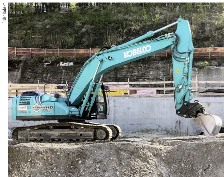
Der Hybridbagger SK210 von Kobelco vereint zwei energetisch wirksame Ansätze in seinem Hybridkonzept: eine ausgefällte Hydrauliköl-Rückführung im Ausleger und ein Energiespeicherkonzept zum Abdecken von Lastspitzen.
