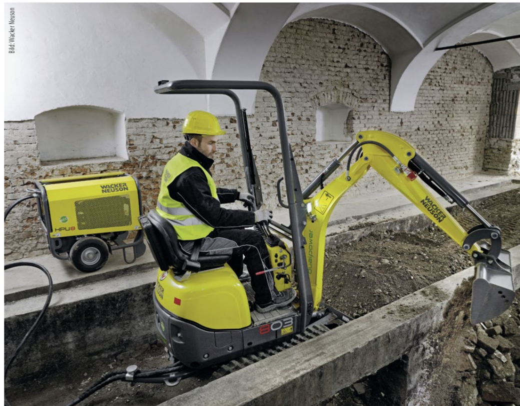
Kein wirklicher Hybridbagger, aber eine Maschine mit zwei Antriebsmöglichkeiten ist der 803 dual power von Wacker Neuson. Anstelle des Dieselmotors kann man den Bagger auch von einer Hydraulikstation versorgen.
