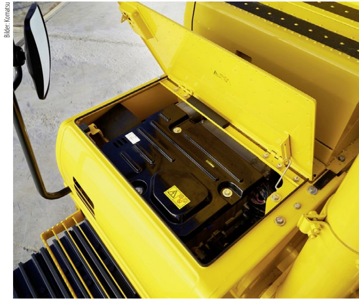
Einen der derzeit grössten Hybridbagger bietet Komatsu mit dem Modell HB365LC/NLV-3 (36 Tonnen). Sein Hybridsystem umfasst im Wesentlichen den Motor-Generator für den Schwenkantrieb (links) und einen Pufferspeicher.
