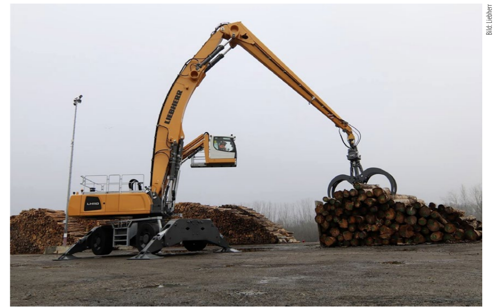
Liebherr verbaut Hybridtechnologie in Umschlagmaschinen. Dieser LH 100 M Port mit ERC-System nutzt die Abwärtsbewegungen des Auslegers zur Energierückgewinnung.
