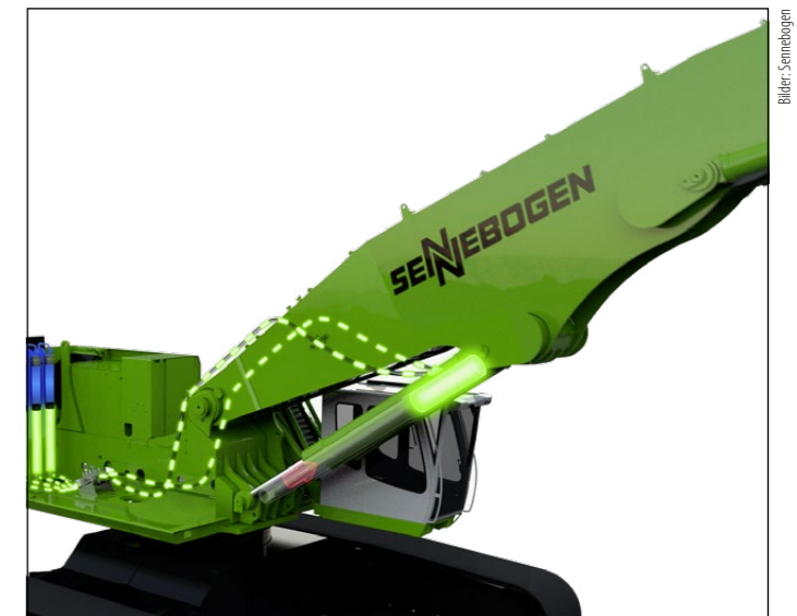
Sennebogen setzt auf verschiedene Ansätze zur Energieeinsparung. Das Green Hybrid System funktioniert auf Diesel- genauso wie auf Elektromaschinen. Eine Kombination aus Hydraulikzylinder am Ausleger und Gasdruckspeicher gewinnt beim Arbeitsvorgang Energie zurück.
