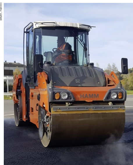
Die Tandemwalze Hamm HD+ 90I PH arbeitet mit Power-Hybrid-Antrieb. Das System arbeitet wie ein Pumpspeicherwerk: Bei Normallast befüllt eine Pumpe einen hydraulischen Speicher, der seine Energie bei Lastspitzen wieder abgibt.
