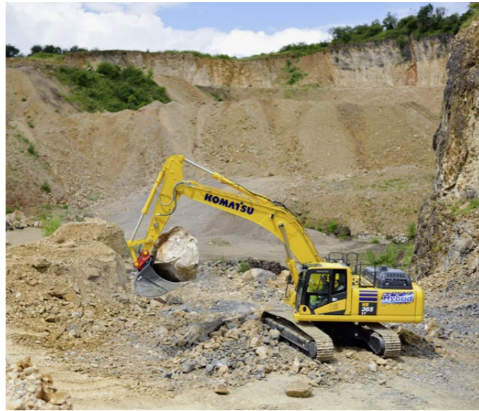
Einen der derzeit grössten Hybridbagger bietet Komatsu mit dem Modell HB365LC/NLV-3 (36 Tonnen). Sein Hybridsystem umfasst im Wesentlichen den Motor-Generator für den Schwenkantrieb (links) und einen Pufferspeicher.
