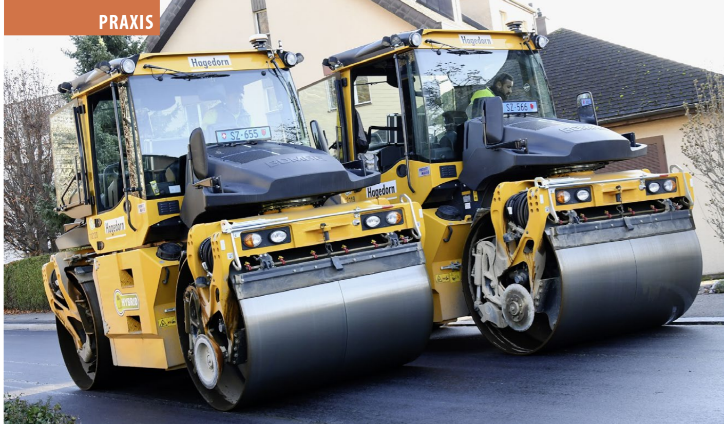
Zwei nagelneue Bomag-Hybridwalzen arbeiten bei der Firma Hagedorn AG. Ihre Pionier-Baustelle hatten sie in Rapperswil-Jona. Ihr hydraulisches Hybrid-system fängt Lastspitzen ab und senkt den Verbrauch um bis zu 20 Prozent.
