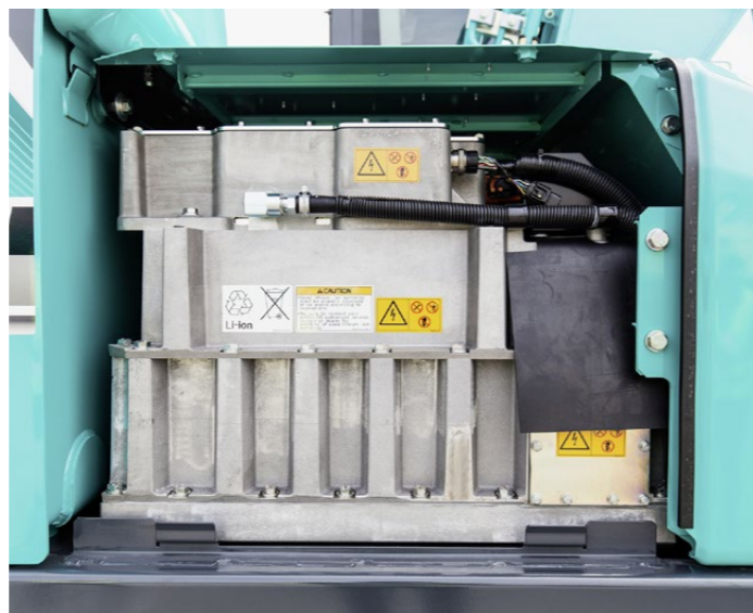
Der Hybridbagger SK210 von Kobelco vereint zwei energetisch wirksame Ansätze in seinem Hybridkonzept: eine ausgefällte Hydrauliköl-Rückführung im Ausleger und ein Energiespeicherkonzept zum Abdecken von Lastspitzen.
