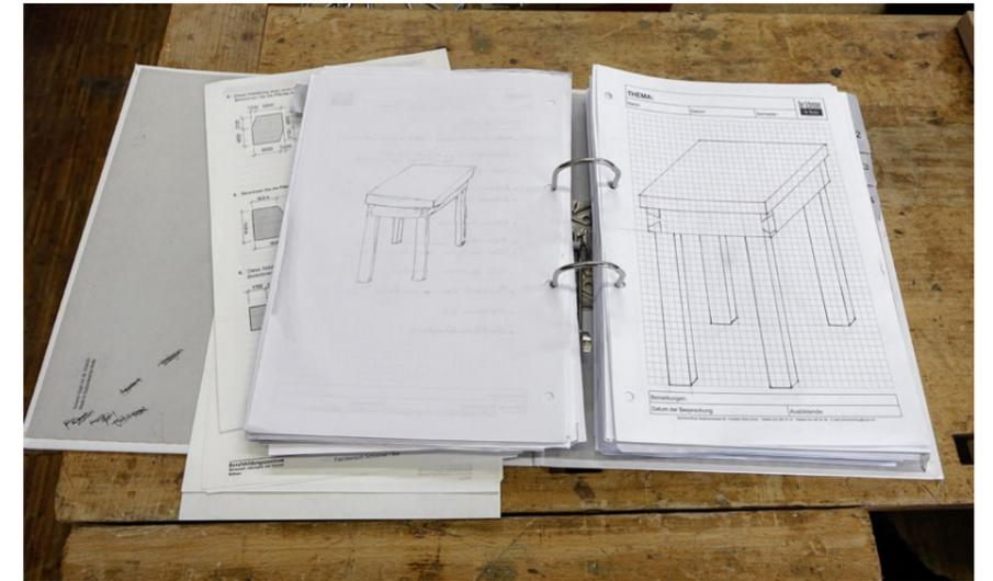
Skizzieren und technisches Zeichnen gehören zu den Grundkenntnissen eines Schreiners und werden deshalb im Lehrgang unterrichtet. Auch der Beistelltisch entsteht nach genauen Plänen.
