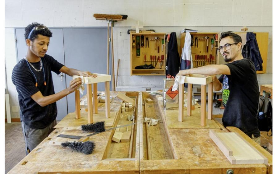
Semere Andebrhan und Basir Golbaig (rechts) im Endspurt. Das Gestell wird nochmals geschliffen, danach muss nur noch die Tischplatte angebracht werden. Zum Abschluss wird das Tischlein geölt.
