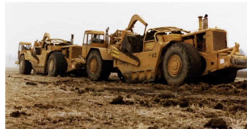
Doppelmotor-Scraper sind mehrheitlich für den Push-Pull-Betrieb ausgerüstet.
