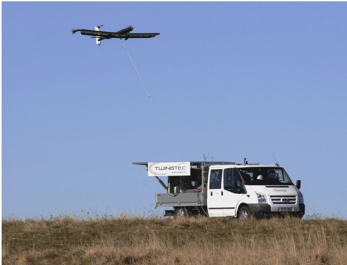
Erfolgreicher Testflug im Herbst 2018 auf den Höhen des Chasseral: Der TwingTec-Prototyp T 28 startete selbstständig von seinem Basisfahrzeug, kreiste 30 Minuten lang autonom in der Luft, produzierte elektrische Energie und landete wieder auf der Startplattform.
